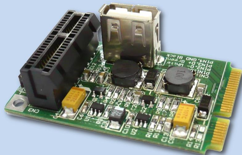
PM2は、MiniCardスロットにPCI Express x1 拡張カードおよびUSB デバイスを接続可能な開発用治具です。MiniCard を製作することなく既存のPCI Express x1 拡張カードやUSB デバイスをMiniCardスロットで試験することが可能です。
