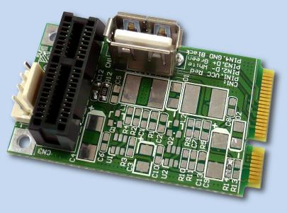
PM2C は、MiniCard スロットに PCI Express x1 拡張カードおよび USB デバイスを接続可 能な開発用治具です。 MiniCard を製作する ことなく既存の PCI Express x1 拡張カード や USB デバイスを MiniCard スロットで試験 することが可能です。
